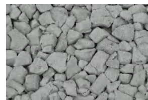
転圧後 (1t 振動ローラー 4回後)
